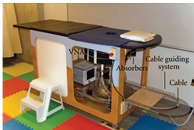
شکل ۶: سیستم نسل نخست تصویربرداری دانشگاه Calgary [۲۱]
