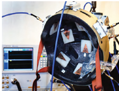
شکل ۱۷: سیستم تصویربرداری نسل اول دانشگاه Chalmers برای تشخیص عوارض مغزی [۳۸].
