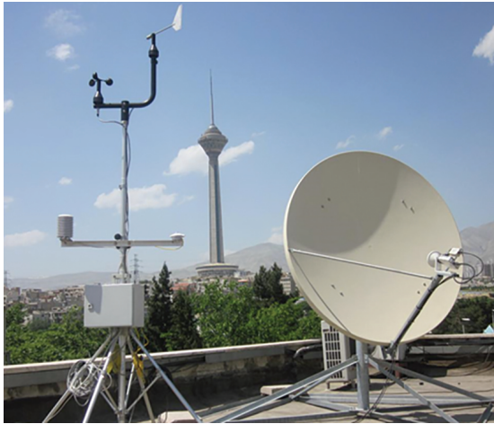
شکل ۹: چیدمان اندازه‌گیری سیگنال و پارامترهای هواشناسی پژوهشگاه ارتباطات و فناوری اطلاعات [۸].
