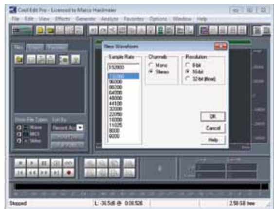
شکل ۱۳: تنظیمات ایجاد فایل جدید شامل فرکانس نمونه برداری و رزولوشن نمونه ها در نرم افزار CoolEdit
