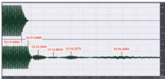
شکل ۱۵: سیگنال دریافتی از کارت صوت در فرکانس ۳ کیلو هرتز
