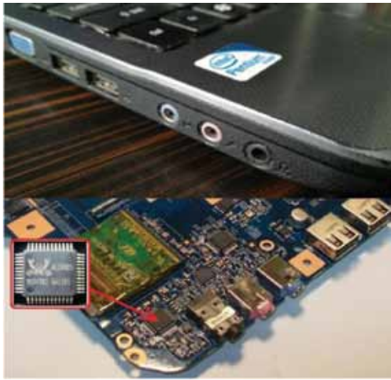
شکل ۳: کارت صوت مورد استفاده در این پژوهش، بالا: ورودی های کارت صوت، پایین: تصویر کارت صوت مجهز به چیپست ALC888S روی مادربرد
