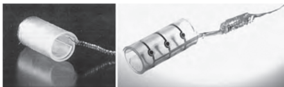
شکل ۴: نمونه‌ای از الکترودی Cuff از جنس سیلیکن-پلیاماید [۱۱]
