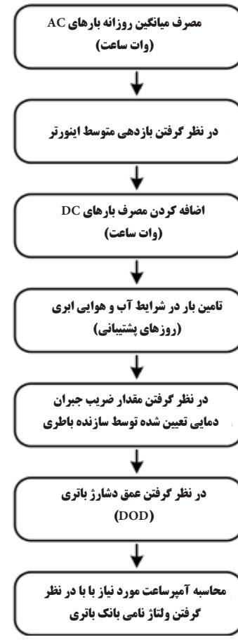
شکل ۱: روند تعیین ظرفیت باتری [۶]
