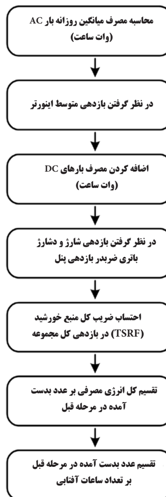
شکل ۳: روند تعیین ظرفیت پنل [۶]
