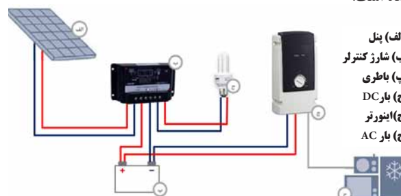
شکل ۴: شماتیک یک سیستم فتوولتائیک جدا از شبکه
