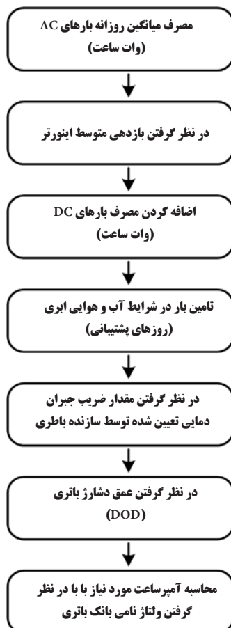
شکل ۱: روند تعیین ظرفیت باتری [۶]
