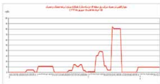
شکل ۲: نمودار کاهش نیاز مصرف در شبکه برق خراسان متأثر از همکاری صنایع در طرح تعطیلات و تعمیرات (۱۵ خرداد لغایت ۱۵ شهریور ۱۳۹۳)
