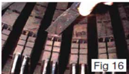
شکل (۱۶): آزمون چاقو برای چک کردن لقی هسته استاتور
