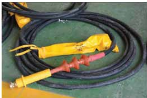
شکل ۶: کابل تغذیه ترانسفورمر
