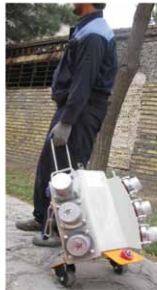
شکل ۷: کلید چمدانی ۲۰ کیلوولت قابل حمل
