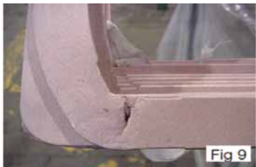
شکل (۹): ترک در سیم‌پیچی (شین) روتور در اثر تنش خستگی کوتاه‌مدت در مس
