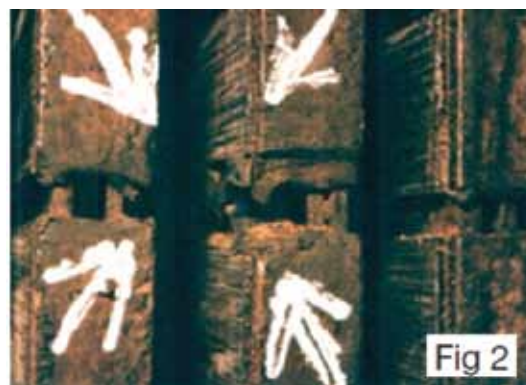
شکل (۲): آسیب دیدگی آهن هسته استاتور
