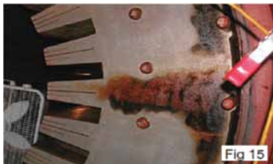
شکل (۱۵): آسیب دیدگی هسته استاتور
