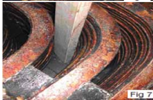
شکل‌های (۶) و (۷): اعوجاج سیم‌پیچی‌های دور انتهایی روتور
