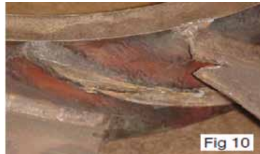
شکل (۱۰): ترک در پره‌های فن دوار در اثر خستگی درازمدت
