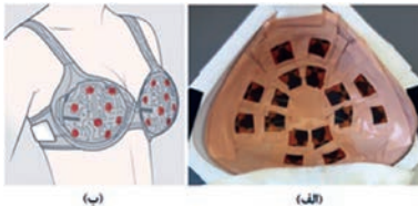
شکل ۱۰: سیستم نسل دوم تصویربرداری دانشگاه McGill. (الف) نحوه قرارگیری آنتن‌های مایکرواستریپ و (ب) نحوه استفاده و تصویربرداری از بیمار [۳۰].
