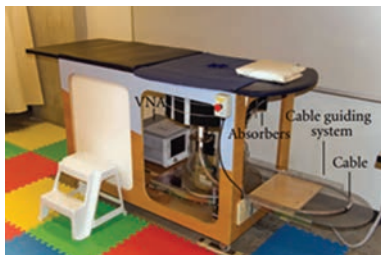
شکل ۶: سیستم نسل نخست تصویربرداری دانشگاه Calgary [۲۱]
