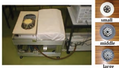
شکل ۱۱: سیستم تصویربرداری دانشگاه Shizuoka برای تشخیص سرطان سینه [۳۱]. سال ۲۰۲۰ با تغییراتی در ساختار اندازه‌گیری بهبود داده شد [۳۰]. شکل (۱۰) سیستم نسل دوم دانشگاه McGill را نشان می‌دهد که از آرایه ۱۶ عنصری آنتن مایکرواستریپ (Microstrip Antenna) قابل انعطاف استفاده می‌کند [۳۰].
