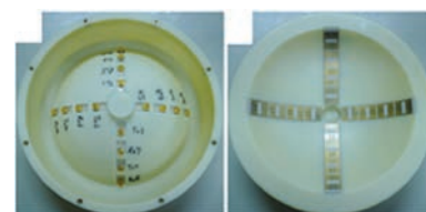
شکل ۱۴: ساختار قرارگیری آرایه آنتن‌ها در سیستم HU [۳۶].
