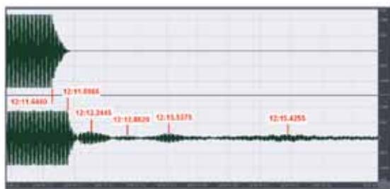
شکل ۱۵: سیگنال دریافتی از کارت صوت در فرکانس ۳ کیلو هرتز
