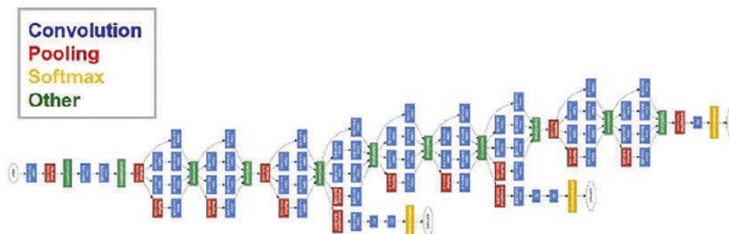
شکل ۸: مدل شبکه عصبی کانولوشن گوگلنت با ماژول‌های Inception به عنوان عمیق‌ترین CNN موجود [۱۵]
