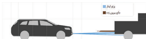
شکل ۱: عدم برخورد پرتوهای لیدار با مانع بیرون زده [۸]
