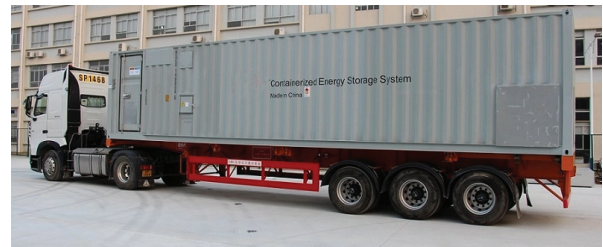
شکل ۴: یک سیستم ذخیره انرژی قابل حمل [۲۹]
