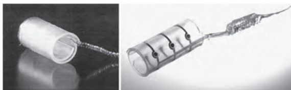
شکل ۴: نمونه‌ای از الکترودی Cuff از جنس سیلیکن-پلیاماید [۱۱]
