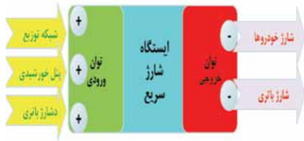
شکل ۲: شمای کلی توانهای ورودی و خروجی به ایستگاه
