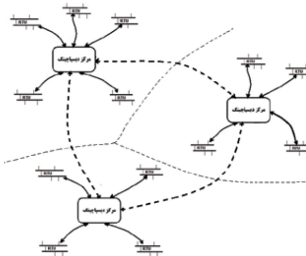
شکل ۲: سیستم کنترل نامتمرکز
