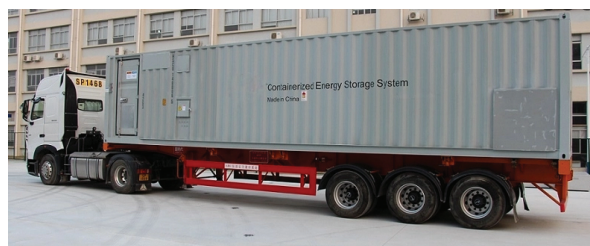
شکل ۴: یک سیستم ذخیره انرژی قابل حمل [۲۹]
