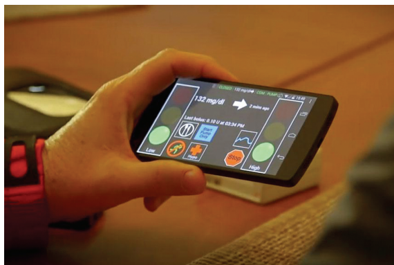
شکل ۹: سامانه نمایش، کنترل و اعلام هشدار مورد استفاده در گوشی های هوشمند جهت کنترل سطح گلوکز خون برای بیماران دیابت نوع یک [۳۰] همراهی پیوسته سیستم نمایش، کنترل و تزریق انسولین با بیمار در طول ساعات شبانه روز، ایده پیاده سازی روش های نمایش و کنترل
